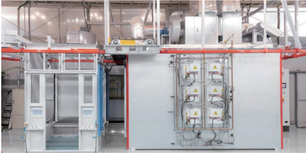
写真2 愛知ラボ外観【塗装ブース（左）とサンキス乾燥炉（右）】
